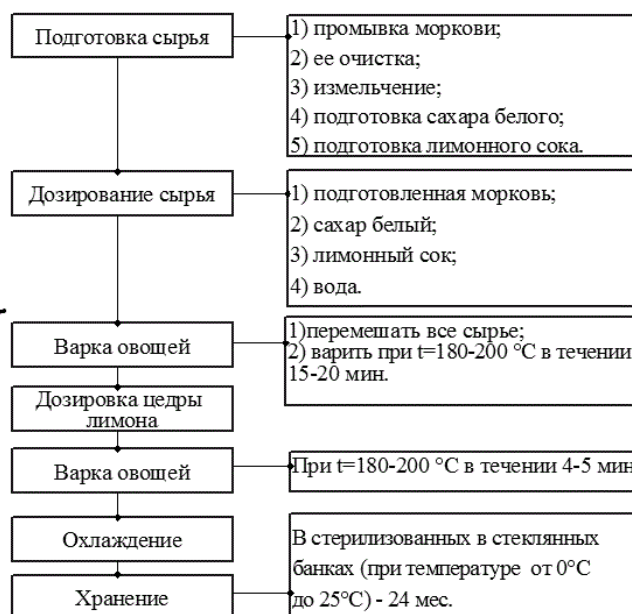
Рисунок 1 – Технологическая схема получения джема из моркови
