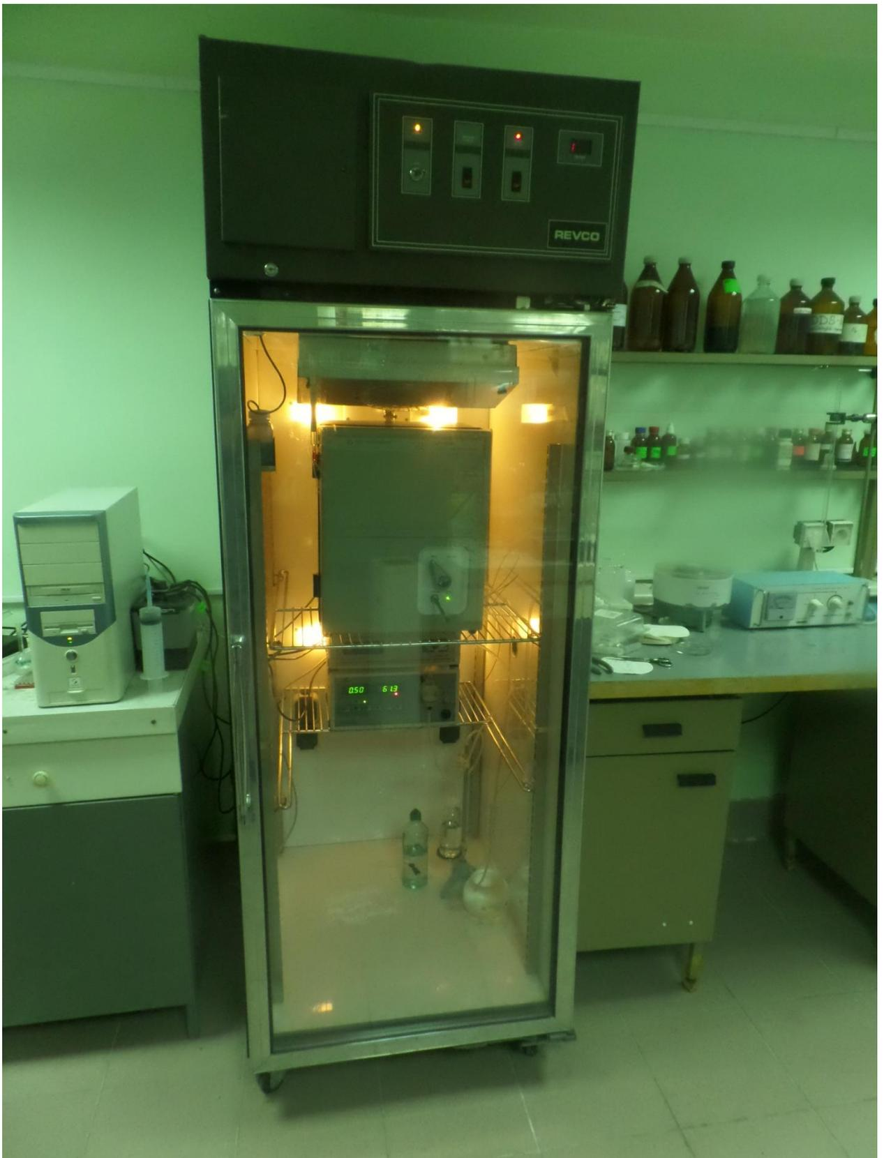
Рис.6. Рефрижератор хроматографический (Голландия).
